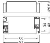
**Scheda tecnica Osram LED Driver Optotronic FIT 20/220 240/500 CS**
